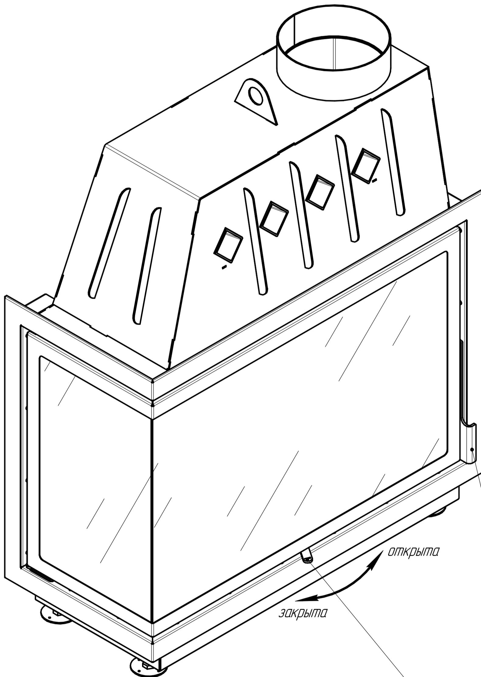
*Ручка регулировки подачи воздуха в топочную камеру
